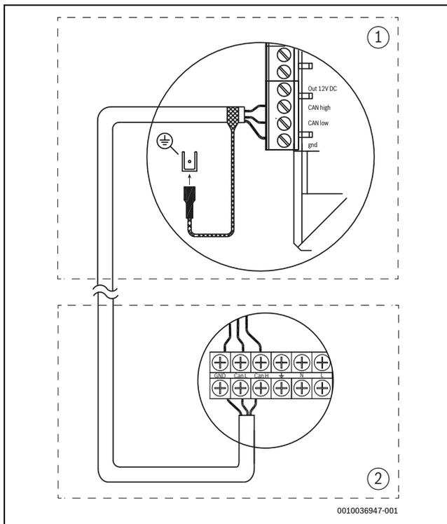
Fig. 20 Connexion CAN-BUS
