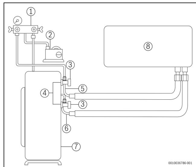
Fig. 18 Contrôle de vide, de chargement et d'étanchéité
