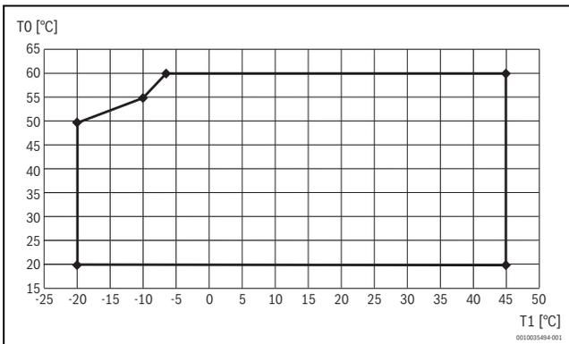
Fig. 24 Plage de fonctionnement de la pompe à chaleur en mode chauffage sans chauffage d'appoint
