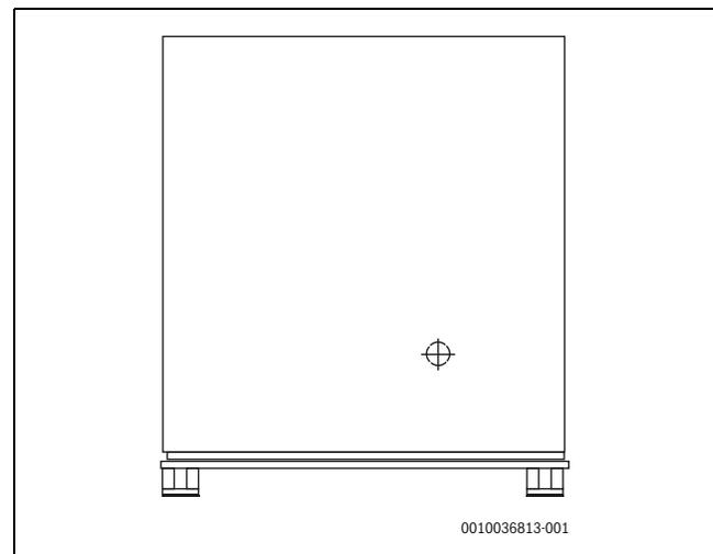
Fig. 5 Emballage avec indication du centre de gravité
