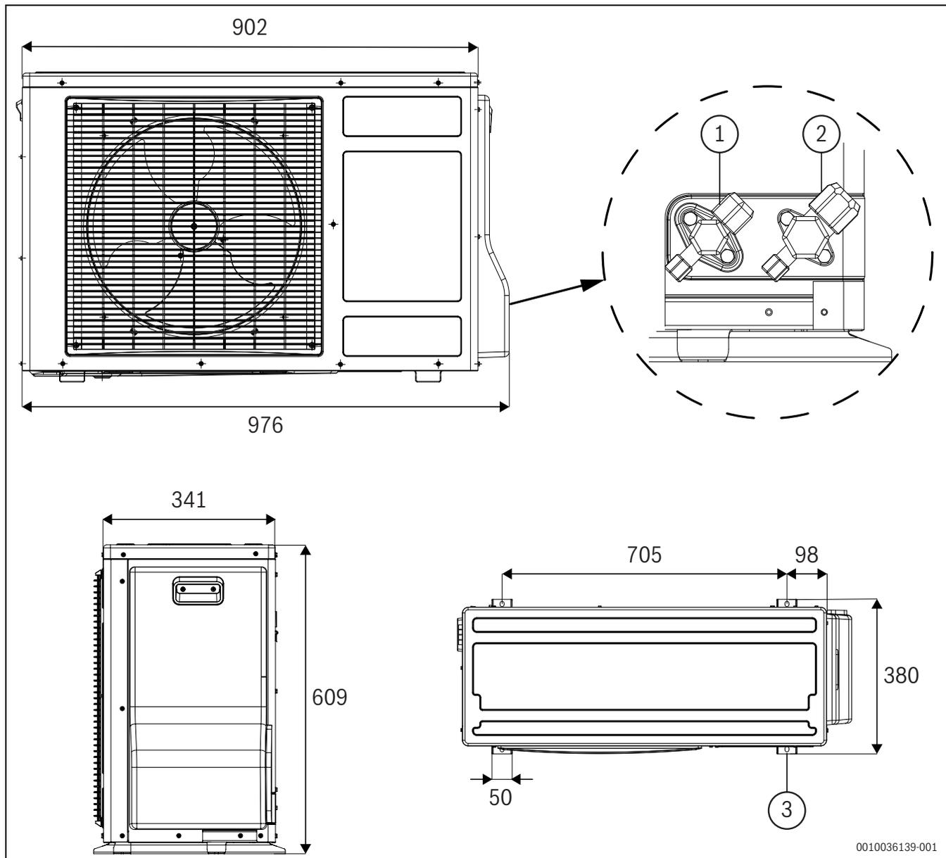
Fig. 2 Dimensions de l'unité extérieure CS3400iAWS 4 OR-S
