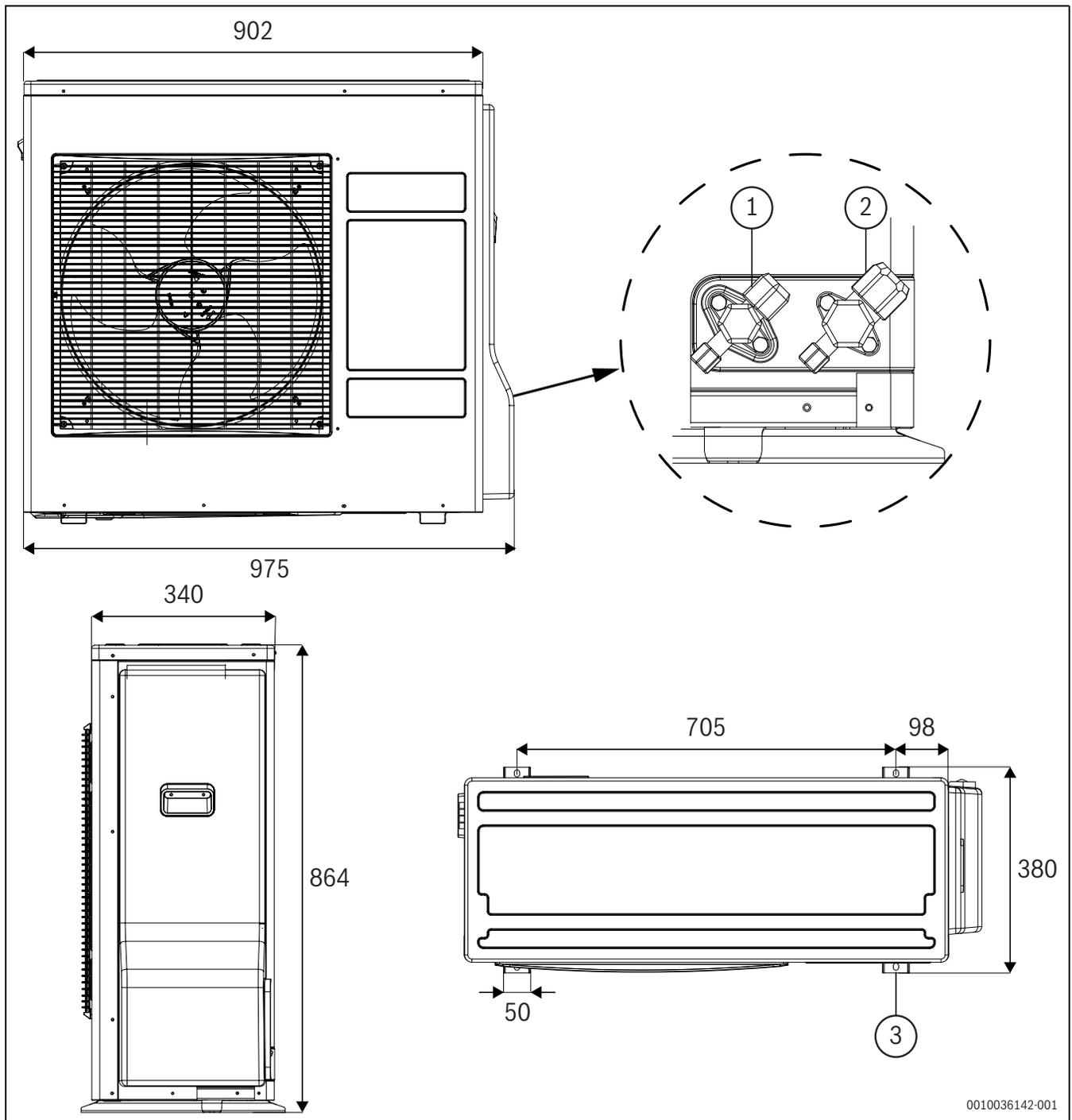
Fig. 3 Dimensions de l'unité extérieure modèle CS3400iAWS 6 OR-S, CS3400iAWS 8 OR-S et CS3400iAWS 10 OR-S
