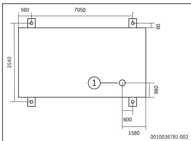
Fig. 7 Plaque inférieure de l'unité extérieure (mm)
