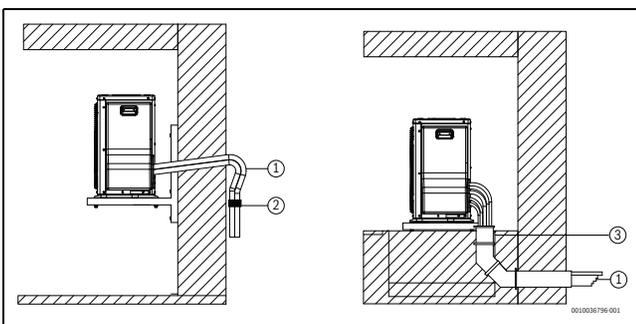
Fig. 17 Raccordement de l'unité extérieure à l'unité intérieure
